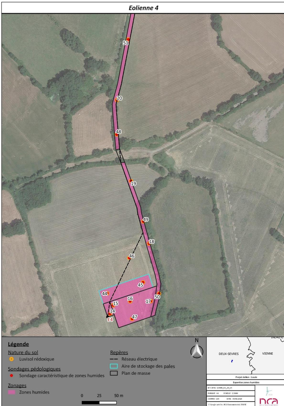
**Figure 16 : Localisation des sondages pédologiques sur le plan de masse de l'éolienne 4**
